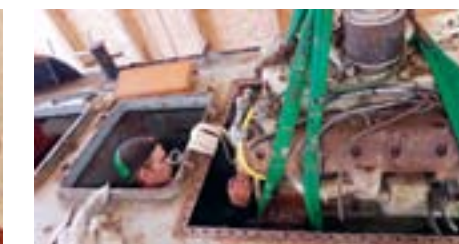
Kraftakt: Philip Richter hilft beim Ausbau des Motors. © Museum Lotsenboot Kapitän Mussehl e.V.
