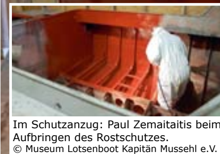
Mit dem Rostschutz hat im September der Wiederaufbau begonnen. © Jens Neumann
